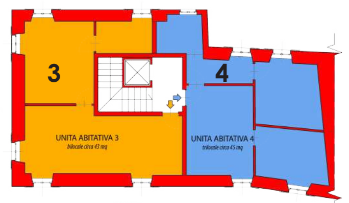
Pianta piano primo -Unità abitative scala 1:200
