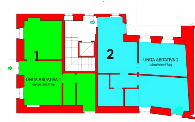
Pianta piano terra -Unità abitative scala 1:200
